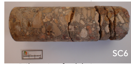
SC6 Délaminé en fond de trou + qq vacuoles
